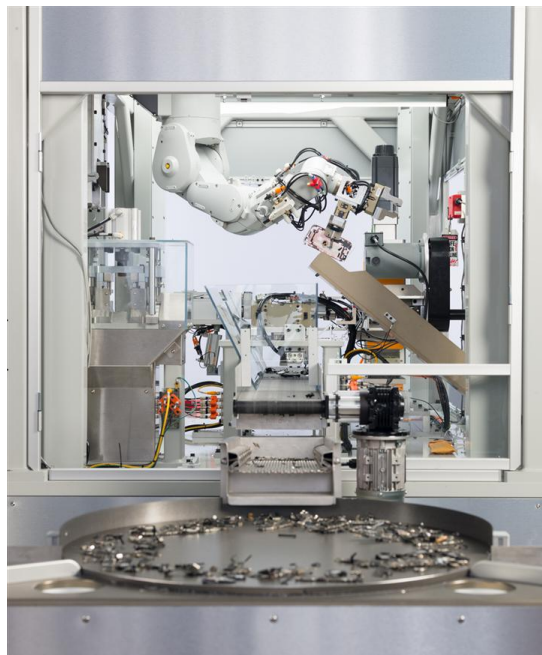
▲iPhone 拆解機器人「Daisy」平均一分鐘銷毀三台 iPhone、一小時銷毀 200 台手機。
